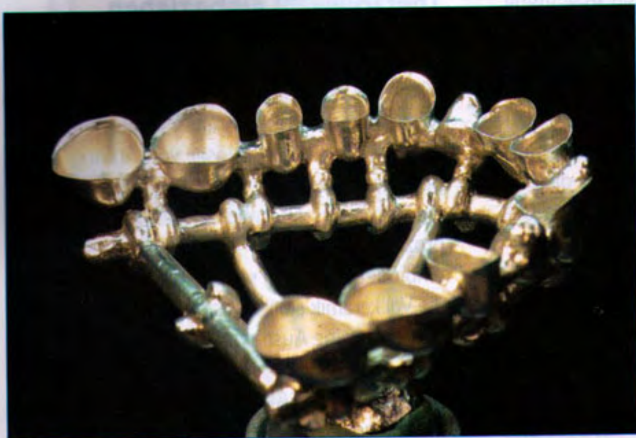
Abb. 12: ... und nach dem Guss. Der Aufwand für das Aufpassen, Ausarbeiten etc. ist minimal.
