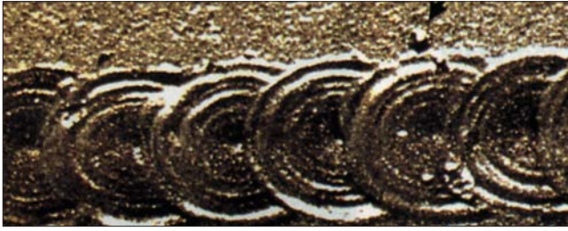
Figura 7A. Cordón realizado con soldadura TIG
