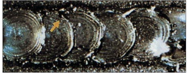
Figura 7B. Cordón realizado con soldadura láser
