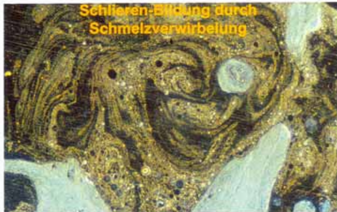
Abb. 11b Mikroskopische Wiedergabe der Schmelzverwirbelung in der Laserschweißnaht einer „Hybridschweißung“
