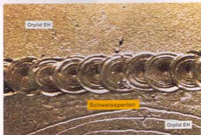
Abb. 1 Makroskopische Wiedergabe der Schweißraupe einer „homogenen“ Schweißung bei einer hochgoldhaltigen Gusslegierung („Orplid EH“)
