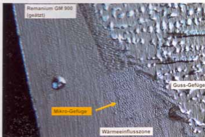
Abb. 10 Mikroskopische Wiedergabe der Übergangszone zwischen dem grobkörnigen Gussgefüge (rechts) der NEM-Legierung und dem feinkörnigen Mikrogefüge in der Plasmaschweißnaht (links).
