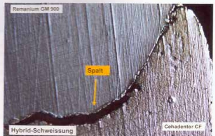
Abb. 7 Mikroskopische Wiedergabe der Fügezone einer „Hybridschweißung“
