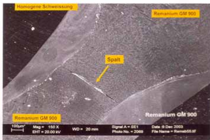
Abb. 8a REM-Wiedergabe einer „homogenen“ Plasmaschweißung mit Spaltbildung
