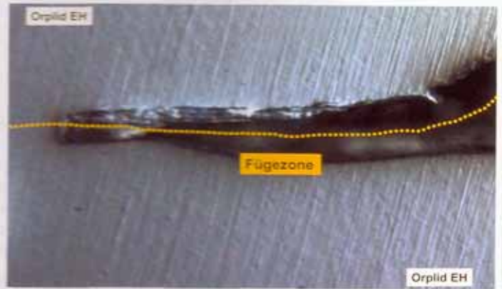
Abb. 4 Makroskopische Wiedergabe der Schweißraupe einer „Hybridschweißung“ zwischen einer Modellguss- („Remanium GM 900“) und einer Edelmetalllegierung („Cehadentor CF“)
