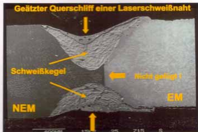
Abb. 9 REM-Wiedergabe einer „hybriden“ Laserschweißung mit Spaltbildung
