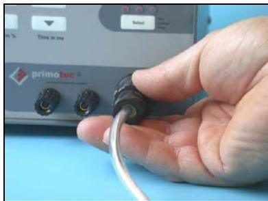
2. Conecte a peça de mão introduzindo-a na tomada prevista a esta função a direita.
