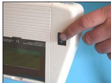
50. A iluminação da lupa é controlada com um interruptor que se encontra na parte direita superior da lupa. Também funciona se a Phaser mx1 está apagada.
