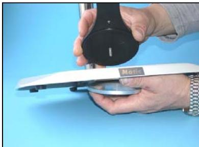
14. Coloque a base de cor negra no tripé do microscópio e posicione a placa de cor negra desde baixo.
