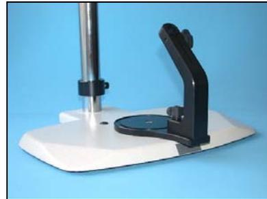
16. A aplicação mais fácil para fixar a base e a placa no tripé é segurar o parafuso de chave allen e girando a placa desde baixo..
