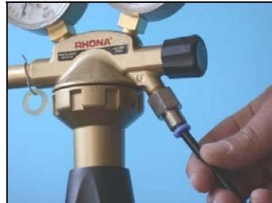
64. Introduza o extremo livre do cabinho de argon, já conectado a unidade de controle, na conexão acoplada rápida do redutor de gás.
