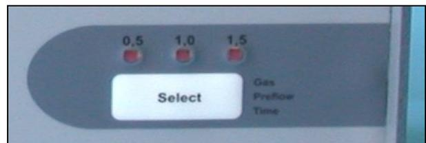
O fluxo de gás de argon anterior se ajusta mediante o botão "Select". O indicador vermelho indica se está selecionado 0,5 segundos, 1,0 segundos ou 1,5 segundos.
