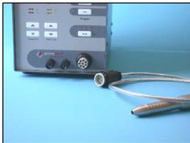
3. Preste atenção se a guia da conexão da peça de mão corresponde com a ranhura da tomada.
