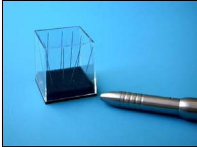
51. A Phaser mx1 é distribuída com 10 eletrodos especiais de volfrâmio. Cada eletrodo tem uma vida útil de uns 1000 impulsos mínimos.
