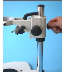
18. A continuação, fixe o anel de tal forma que, em caso de que o parafuso se solte, consiga manter ajustado o porta-microscópio na mesma altura.
