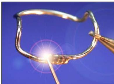
3. Mediante 5 ou 6 pontos mais, conseguirá uma união permanentemente resistente que poderá repassar facilmente com instrumentos rotativos...
