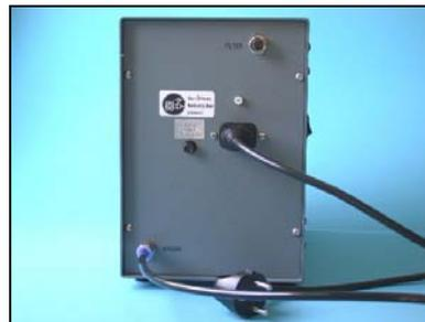
10. Para voltar a retirar o cabinho, desparafuse a mão o anel e tire o cabinho.
