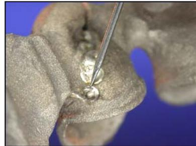
4. depois de ter fixado a ponte com os primeiros pontos, pode levantá-la do modelo e fechar o resto com um cordão...
