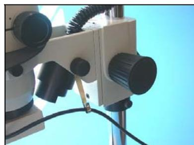
39. Com o botão giratório no porta-microscópio se consegue uma imagem nítida. Se não for possível, deve-se variar a altura de todo o porta-microscópio.
