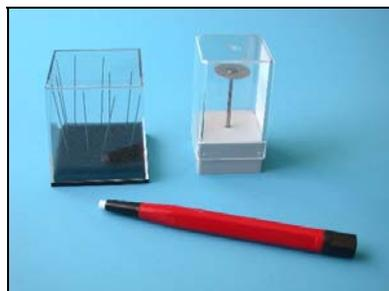
60. O disco diamantado serve para apontar os eletrodos. O pincel de vidro serve para limpar o ponto soldado da fuligem (especialmente em caso de utilizar ligas Co-Cr).
