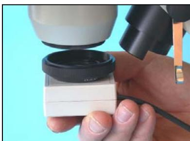
25. Retire o anel protetor debaixo da lente e coloque a proteção anti-ofuscante eletrônica (Diafragma)...
