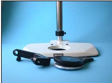
11. Comece a montar o microscópio montando o tripé da peça de mão sobre o tripé do microscópio.
