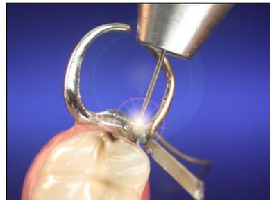
6. Depois levante a prótese do modelo e solde a parte interior do gancho.
