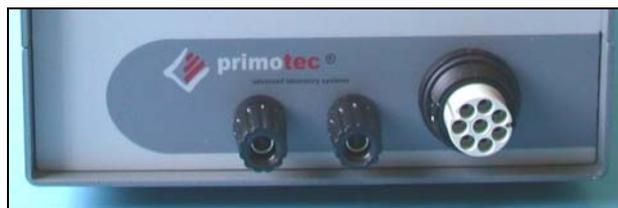
A tomada da direita está prevista para a conexão da peça de mão. (Se foram seguidos os passos deste manual, já deve estar conectada)
