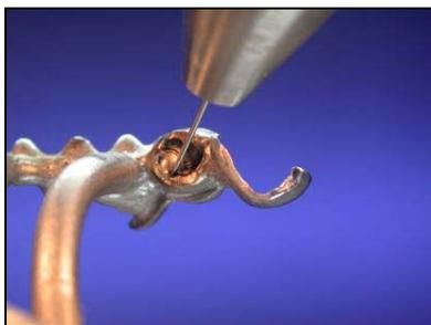
3. Preste atenção para soldar em cruz para evitar qualquer tensão. A continuação, solde os pontos de fixação desde basal.
