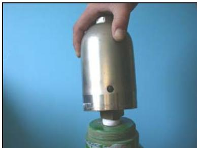
63. Depois de ter protegido adequadamente a garrafa contra quedas, desparafuse a tampa protetora da válvula.
