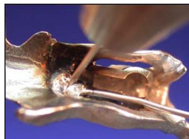
4. Utilize material de aportação para fechar a fenda entre o atache e o esquelético. Aponte com o eletrodo sempre sobre o fio.
