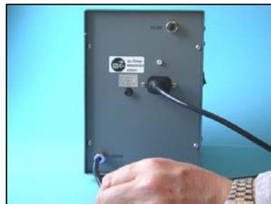
9. Introduza o cabinho do argon (Fornecido com o kit de conexão de gás) no orifício. Feche.
