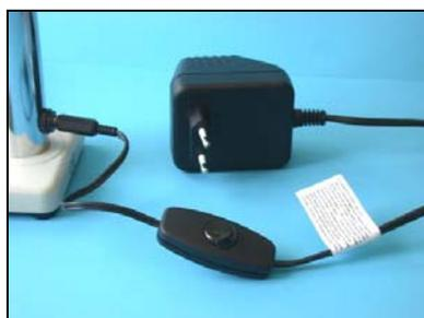
30. Pode acender a iluminação do microscópio com um interruptor do fio permitindo o uso do microscópio independentemente do Phaser mx1..
