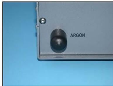
8. Retire a tampa protetora da conexão ao gás de argon (conexão, acoplado rápido do cabinho).
