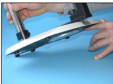
15. Parafuse a placa de cor negra e a base negra com o parafuso da chave allen e aperte a mão.
