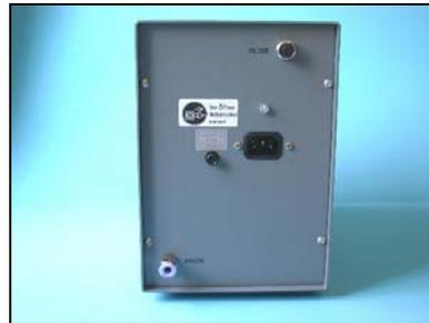
6. Face posterior com tomada de conexão à rede, caixa de fusíveis, conexão para o argon assim como tomada para a proteção anti-fusca (diafragma)
