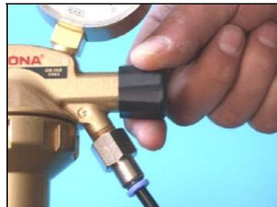
66. O caudal de gás de argon pode ser ajustado com a válvula situada na parte inferior do redutor de gás. Ajuste 4 l/min. (está indicado no relógio da direita).
