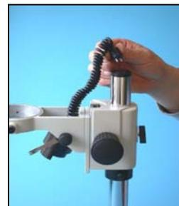
19. Introduza o fio da lâmpada embutida do microscópio no local previsto para isso localizado no extremo superior da haste.
