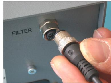
46. Conecte o diafragma LCD ao dorso da máquina de solda Phaser mx1 introduzindo o cabo na tomada onde está escrito FILTER e aperte com a mão.
