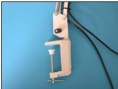
44. Desde cima, introduza o braço giratório da lupa no orifício do dispositivo previsto para isso. A continuação, o braço pode ser girado livremente.
