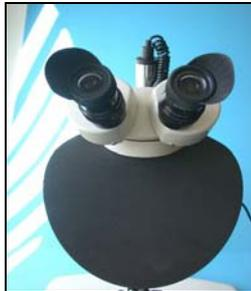
31. Para poder ver bem o objeto a soldar, ajuste primeiro o microscópio. Em primeiro lugar, ajuste a distância dos olhos girando os porta-oculares para fora e ...
