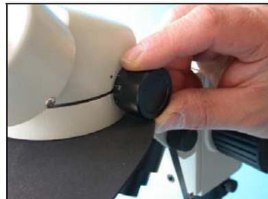
38. Os aumentos do microscópio se ajustam sem escalonar, de 1 a 4, mediante os botões giratórios nos dois lados do microscópio. Este corresponde a uma ampliação de 5 a 20 aumentos.
