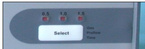
El flujo de gas de argón anterior se ajusta mediante el botón „Select“. El indicador rojo indica si está seleccionado 0,5 segundos, 1,0 segundos o 1,5 segundos.
