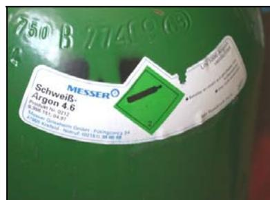
40. Por último, conecte la botella de gas de argón con el Phaser mx1. Se recomienda utilizar un gas de pureza 4.5 o 5.0. (99,995% respectivamente 99,999%)
