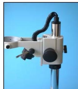
20. La imagen muestra el montaje correcto del portamicroscopio.
