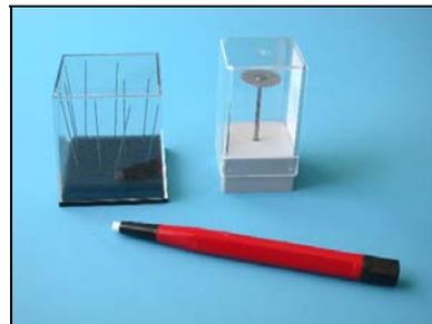
60. El disco diamantado sirve para sacar punta a los electrodos. El pincel de vidrio sirve para limpiar el punto soldado de hollín (especialmente en caso de utilizar aleaciones Co-Cr).
