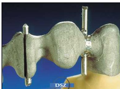
4. de la aleación sino que basta con algunos puntos de fijación. Después de cerrarse completamente debe cortar los extremos del hilo.
