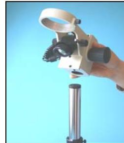
17. Monte el portamicroscopio en el trípode y sujételo apretando el tornillo en la parta posterior.
