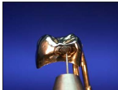
5. Para alisar el material añadido se aumenta la duración del impulso y se reduce la potencia.
