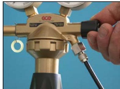
67. Se abre y se cierra la válvula en la parte de la derecha del manómetro.
