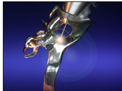
6. ... suelde el otro lado desde basal. Si la distancia tiene el mismo grosor que el hilo, coloque simplemente el hilo en la grieta.
