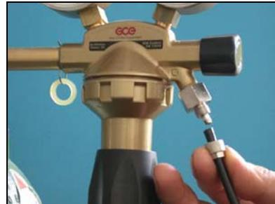
65. Introduzca el extremo libre del manguito de argón, ya conectado a la unidad de control, en la conexión acoplada rápida del reductor de gas.
