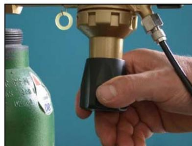
68. El caudal de gas de argón puede ser ajustado con la válvula situada en la parte inferior del reductor de gas. Ajuste 4 l/min. (está indicado en el reloj de la derecha).
