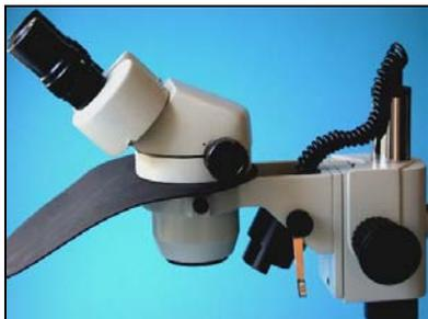
24. La imagen muestra el montaje correcto del microscopio.
