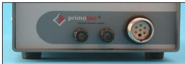
La hembra a la derecha está prevista para la conexión de la pieza de mano. (Si ha seguido fielmente los pasos de este manual, ya debe estar conectada)
