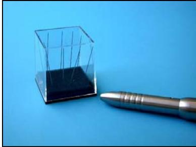
51. El Phaser mx1 es suministrado con 10 electrodos especiales de wolframio. Cada electrodo tiene una vida útil de unos 1000 impulsos mínimos.
