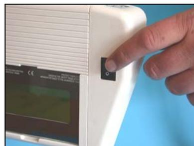
50. Se controla la iluminación de la lupa con un interruptor que se encuentra en la parte derecha superior de la lupa. También funciona si el Phaser mx1 está apagado..
