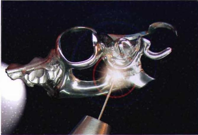
Fig. 14. La soldadura por plasma mediante microimpulsos se cuenta entre las técnicas de unión más estables en la prótesis dental.
