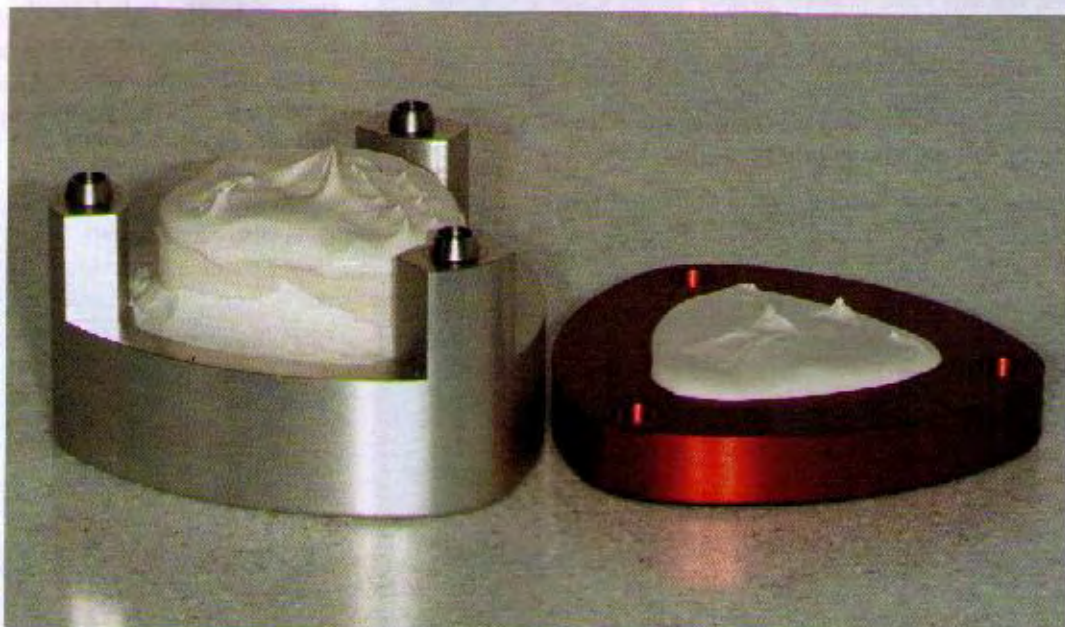
Fig. 22. Yeso en el modelo y la tapa poco antes de unir las dos mitades del aparato.
