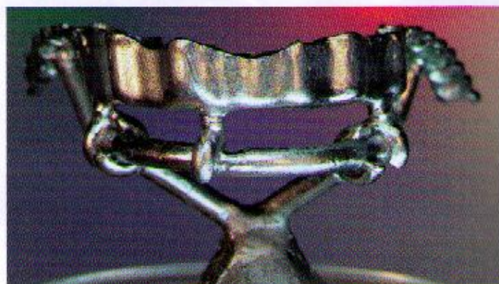
Fig. 39. Se utiliza el procedimiento de colado rápido: estructura terciaria sin revestimiento y chorreada
