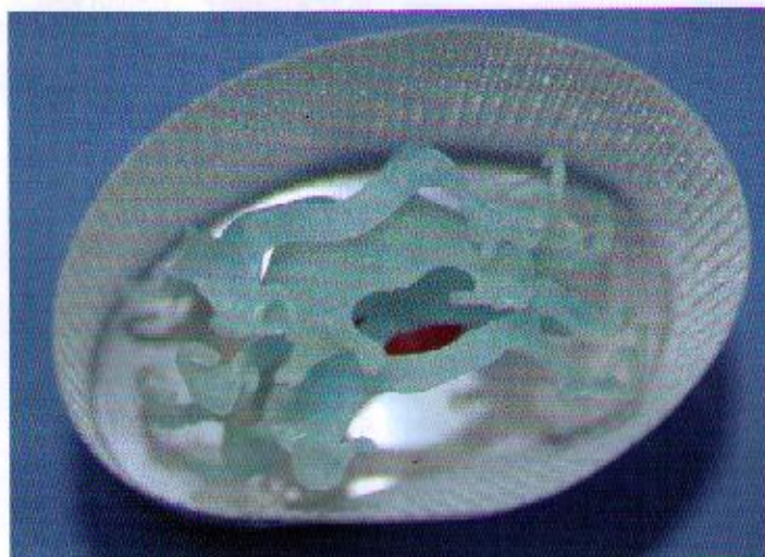
Fig. 8a. Tres piezas coladas en un cilindro: sin ningún problema
