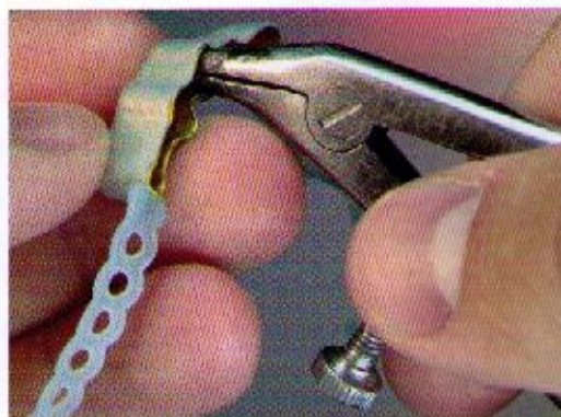
Fig. 36. Con una tenaza para telescópicas se calienta la cera situada entre la estructura galvanoformada y la terciaria. Con ello, la pieza galvanoformada "cae" prácticamente del modelado polimerizado
