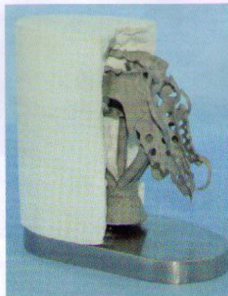
Fig. 7. Una pieza colada limpiamente, con el revestimiento parcialmente eliminado para que pueda verse. El ahorro en masa de revestimiento es claro, y solo se confeccionó un cilindro de colado
