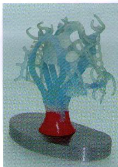
Fig. 6. Con la ayuda de un cono móvil y magnético se coloca el modelado en la mejor posición en la base del cilindro
