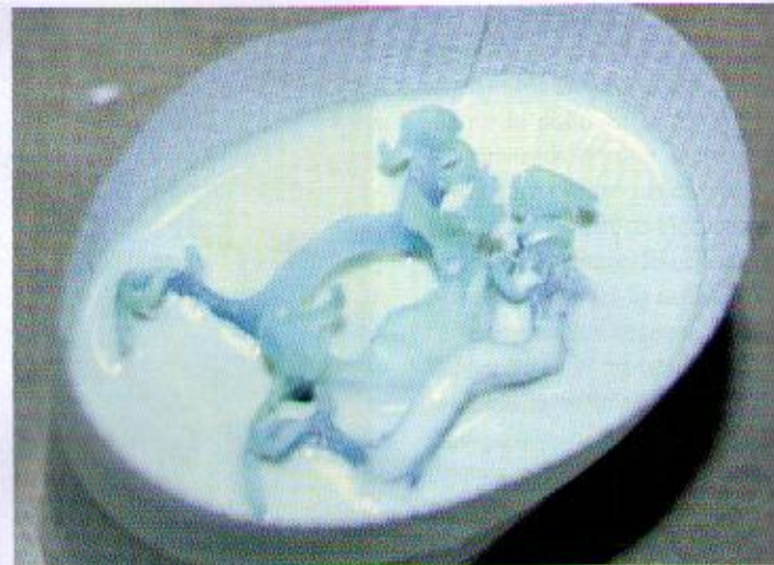
Fig. 8b. Haciendo un revestimiento vertical se minimiza el peligro de la formación de inclusiones de aire en las piezas coladas
