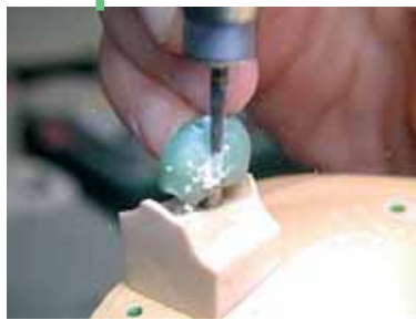
Photo 6 : fraisage sur contour et épaulement
