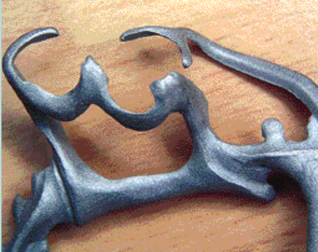
16 Châssis après sablage : il ne reste plus qu'à sectionner les tiges et polir
