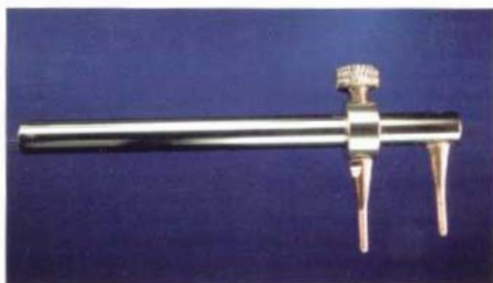
Abb. 2 Der Joker ermöglicht ein verzugsfreies Schweißen. Das Objekt wird über zwei Spitzen fixiert, bevor daran geschweißt wird.
