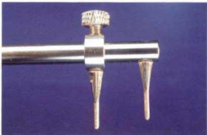
Abb. 4 Mit der Stellschraube ist der Abstand der beiden Spitzen individuell auf das jeweilige Werkstück einstellbar
