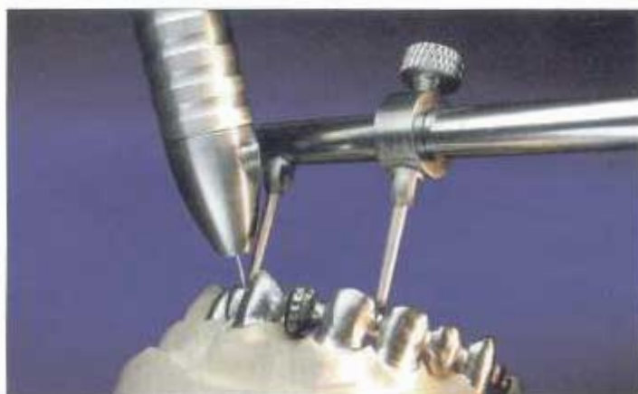
Fig. 7. La pieza a trabajar se lija con el Joker sobre el modelo
