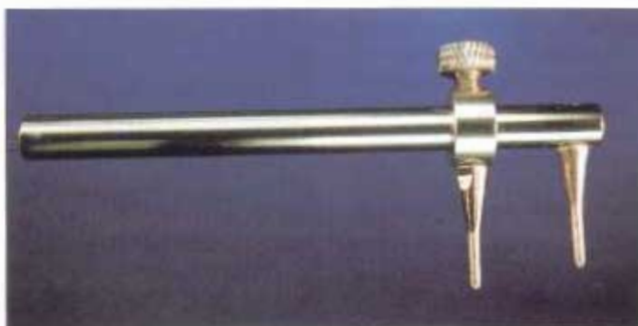
Fig. 2. El Joker permite una soldadura libre de tensiones. El objeto se fija mediante dos puntas, antes de empezar a soldar
