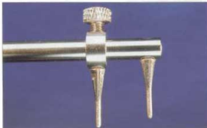
Fig. 4. Una de las puntas se puede mover transversalmente, ajustado a la distancia de ambas puntas según la pieza a trabajar correspondiente
