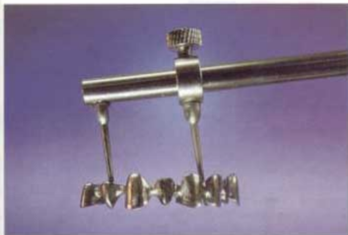
Figs. 11 y 12. El objeto fijado de forma segura puede ser levantado del modelo para seguir soldando.
