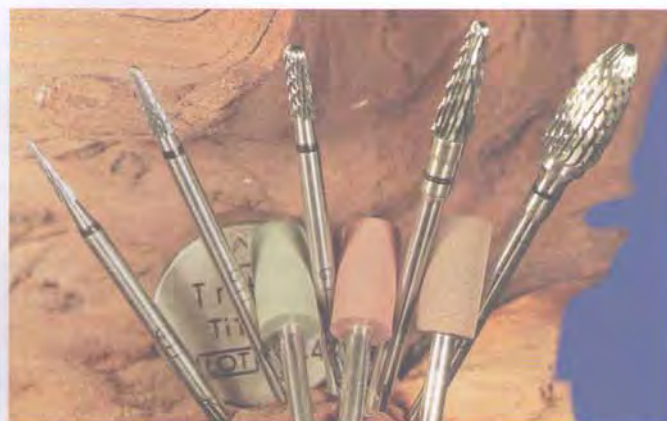
Fig. 3. Instrumentos especiales para el acabado del titanio. Para el trabajado grueso del titanio (GTi) se utilizan fresas de la firma Gebr. Brasseler, Lemgo, Alemania, especialmente desarrolladas para titanio. Éstas contribuyen decisivamente a superar los problemas durante el trabajo con el titanio.
