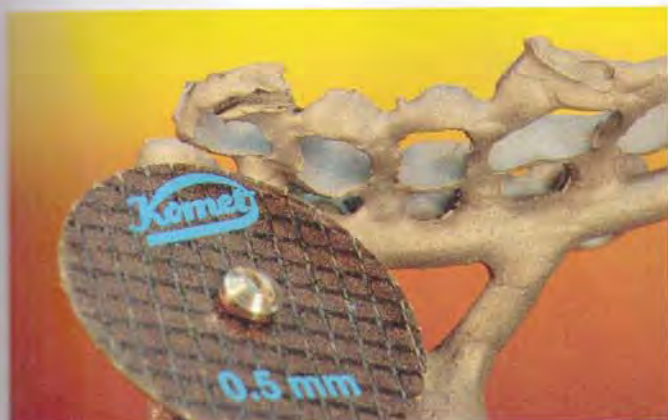
Fig. 11. El corte debe llevarse a cabo sin ejercer presión, dado que el titanio disipa mal el calor y por lo tanto se endurece rápidamente en la zona de corte.
