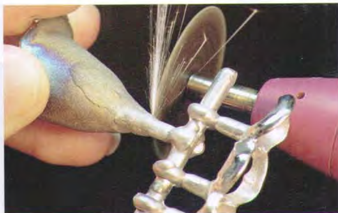
Fig. 12. La técnica de corte muestra el proceso de transformación del titanio en óxido de titanio. Cada chispa pone de manifiesto la oxidación visible con el oxígeno del aire.
