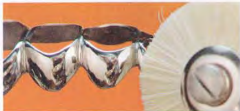
Fig. 17. El pulido de la pieza de trabajo resulta más laborioso: se empieza puliendo de forma cada vez más fina y a continuación se pule a alto brillo mediante la pieza de mano y un cepillo con pasta de pulido de titanio.
