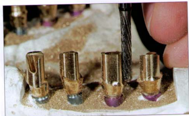
Abb. 23: Feinfräsen der Biolight mit dem H364RGE.
