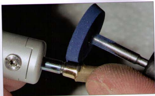
Abb. 21: Ausarbeiten mit blauem Silikonrad und Polierhilfe.
