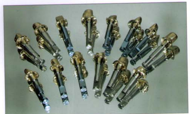
Abb. 35: Im Spiegel zeigt sich nach dem Aufpassen und Polieren eine perfekte Passung.
