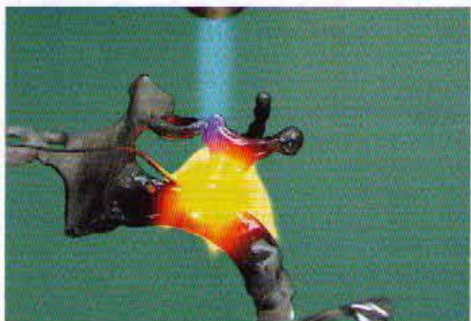
Fig. 5. Los objetos grandes se tienen que calentar de manera uniforme. La elección del quemador aquí es importante.
