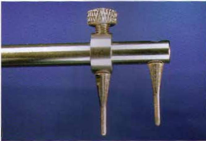
Fig. 15. El tornillo de banco dental «joker» (primotec).
