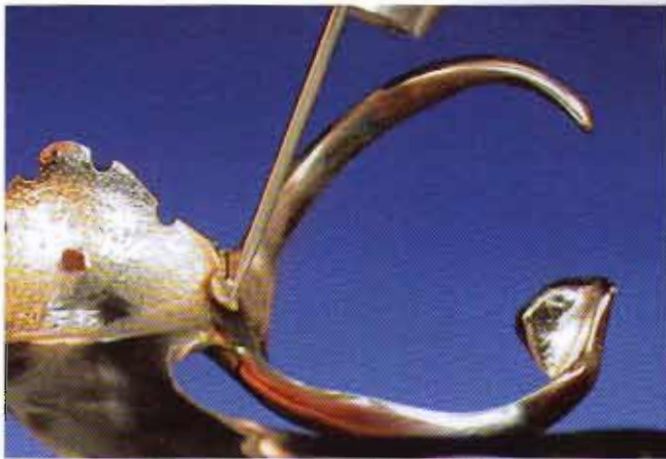
Fig. 14. Soldar hasta una profundidad de aproximadamente 1,3 mm se puede hacer sin problemas.
