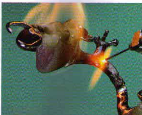
Fig. 6. Boquilla y preparación equivocadas: todo se ve más.
