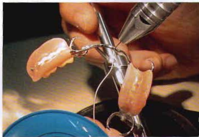
Fig. 18. Se comienza a soldar con el modelo fijo. Sólo cuando el colado siente a la perfección sobre el modelo se puede soldar correctamente.
