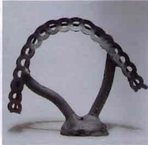
Fig. 28. Pieza colada después del chorreado.
