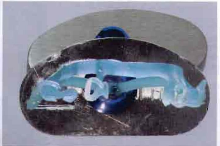
Fig. 14. Revestimiento en posición vertical: como se fija con imanes en la placa de posición, la pieza se puede mover en todas las direcciones, para colocarla exactamente en el medio.
