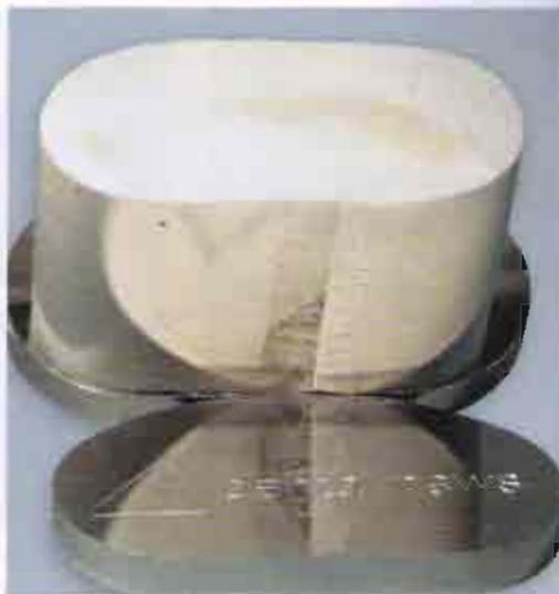
Fig. 18. La envoltura magnética multiusos ahorra desechos y respeta el entorno. El modelo revestido se puede calentar de forma convencional o rápida. Se puede reducir el tiempo de espera en comparación con un revestimiento convencional según las dimensiones del cilindro.
