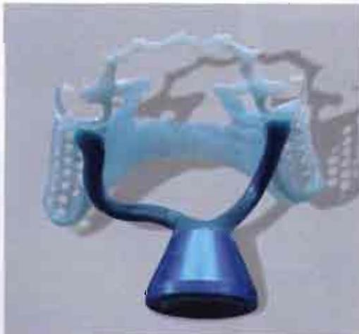
Fig. 16. Ejemplo de colado horizontal: se necesitaron alrededor de 400 gramos de masa de revestimiento, independientemente del tiempo de calentamiento. Esto era antes...
