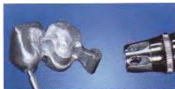
Fig. 21. Con la pistola Airbrush (Hafner) se pulveriza una película homogénea de plata sobre la superficie. Para ello, se cubren también las transiciones de las superficies de conector.
