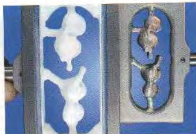
Fig. 4. Armazones de óxido de circonio modelados en cera y confeccionados con ayuda del equipo CerconBrain (Degudent) con piezas de conector. Para el modelado en cera se usaron conectores deslizantes Preci-line.
