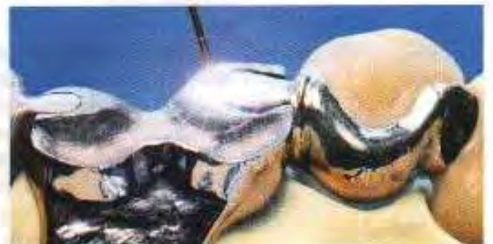
Fig. 36. En el momento en el que el electrodo de plasma se retira de la pieza, continúa el haz de plasma sobre el argón y produce una soldadura puntual, similar a la conseguida por láser.
