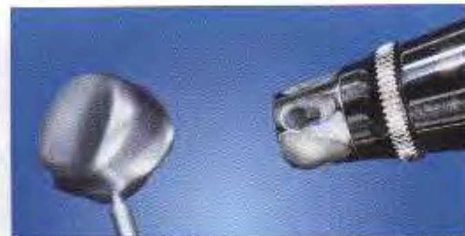
Fig. 22. Para hacer conductora la superficie se aplica la pistola Airbrush. Todas las zonas que no deben recibir oro se tapan con un barniz de cobertura para las áreas de precipitación.
