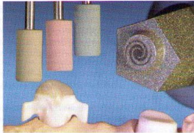
Fig. 2. El grano de los diamantes es cada vez más fino. La codificación cromática desde azul, pasando por rojo y amarillo, hasta blanco minimiza el peligro de confusión.
