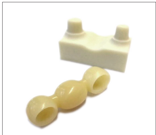
Figura 8: Geometría del objeto de ensayo para la simulación de masticación
