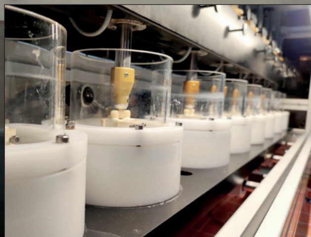
Figuras 6 y 7: Diseño de ensayo de la simulación de masticación para puentes provisionales de largo plazo
