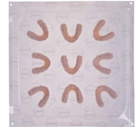
9 tiefgezogene Rohlinge in einem Tiefziehprozess: Biolon für Vacformat V9 2.0
