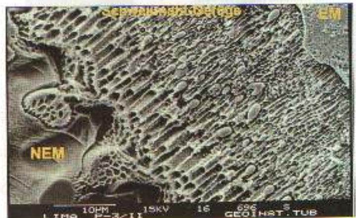
Imagen 12b: Vista por el microscopio electrónico de barrido (REM) de la estructura cristalina de una soldadura por láser.
