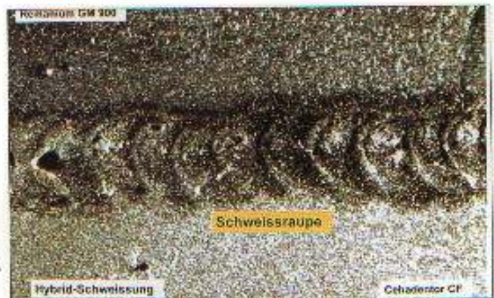
Imagen 4: Vista macroscópica de un cordón soldado de una soldadura híbrida entre una aleación para esqueleticos ("Remanium GM900") y una aleación preciosa ("Cehadentor CF").
