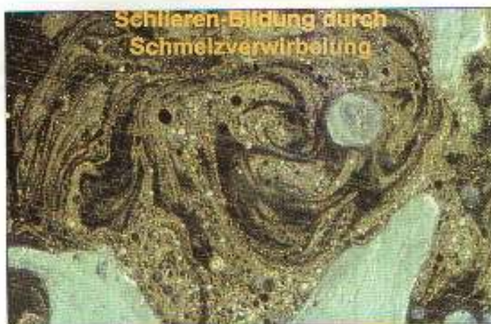
Imagen 11b: Vista microscópica de los remolinos de fusión en la zona soldada por láser de una soldadura híbrida.
