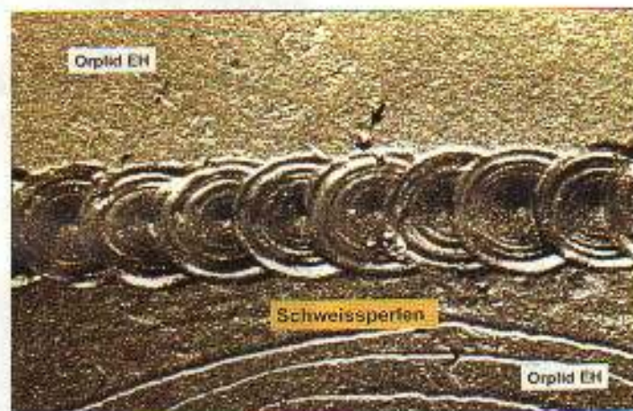
Imagen 1: Vista macroscópica de un cordón soldado de una soldadura homogénea de una aleación de alto contenido en oro ("Orplid EH").
