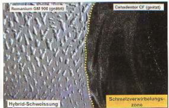
Imagen 11a: Vista microscópica de los remolinos de fusión en la zona soldada por TIG de una soldadura híbrida.
