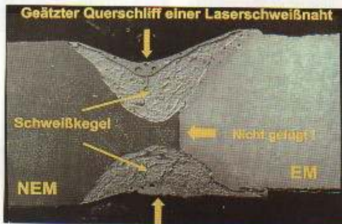
Imagen 9: Vista por el microscopio electrónico de barrido (REM) de una soldadura híbrida por láser dejando la zona central libre.
