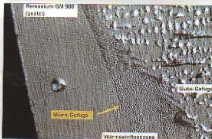
Imagen 10: Vista microscópica de la zona limítrofe entre la estructura cristalina de grueso grano de una aleación no preciosa (a la derecha) y de la estructura de grano fino de la zona soldada (a la izquierda).
