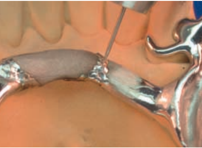
Abb. 3a und 3b Reparatur eines gebrochenen Bügels und Erweiterung an einem Kobalt-Chrom-Modellgussgerüst
