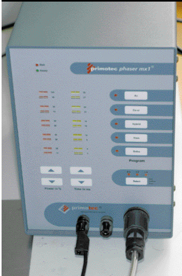
1 Générateur électrique avec ses différentes programmations suivant les alliages en puissance et en temps d'impulsion.
