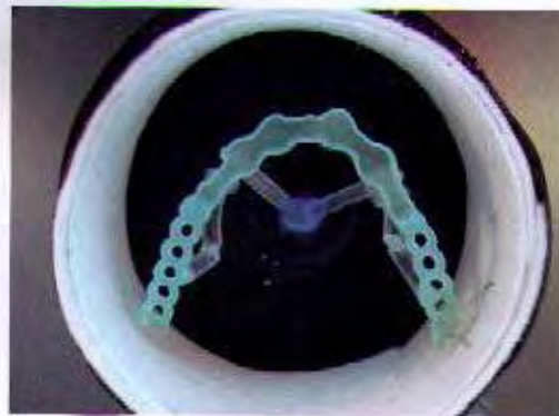
Abb. 38 Statt mit dem Metacon-Muffelsystem vertikal kann auch konventionell horizontal (wie hier in eine 6er-Muffel) eingebettet werden
