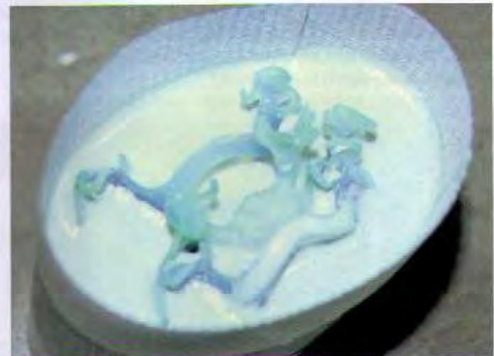
Abb. 8b Durch das vertikale Einbetten reduziert sich die Gefahr von Bläschenbildung an den Gussobjekten
