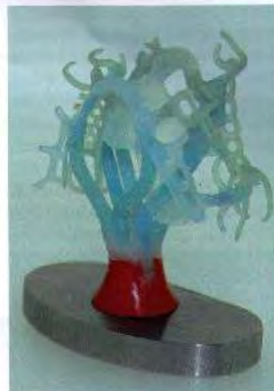
Abb. 6 Mit Hilfe des beweglichen, magnetischen Konus werden die Modellationen in die beste Position auf der Muffelbasis gerückt
