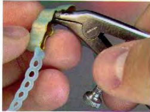
Abb. 36 Das rosa Plattenwachs zwischen der Galvanoplastik und dem Tertiärgerüst wird mit einer heißen Teleskopzange durch das Galvano-Gold erwärmt. So „fällt“ die Galvanostruktur quasi aus der polymerisierten Modellation.
