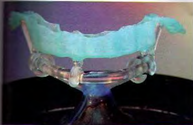
Abb. 37 Auch diese Modellation wird mit primo-click angestiftet
