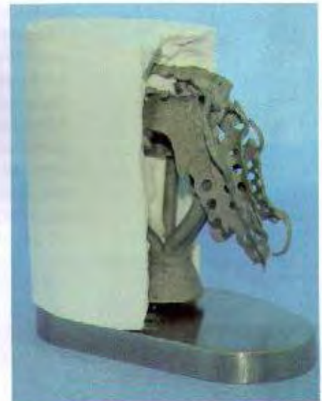
Abb. 7 Ein sauberer Dreier-Guss, zum Beweils nur halb ausgebettet. Die Ersparnis an Einbettmasse ist offensichtlich, es wurde aber auch nur ein Gusskegel erzeugt.
