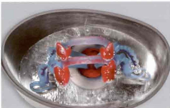
Abb. 33 Zwei verschiedene Arbeiten in einer Muffel, das geht: Nach dem Aufpassen der Teleskope auf dem Modell herrscht nur Begeisterung! Die Manschette besteht aus einer Magnetfolie, die immer wieder verwendet werden kann, also kein Abfallprodukt ist. Die Sockelformer sind auch hier in drei verschiedenen Größen zu haben, was wiederum für alle Größen von Gussobjekten ausreichend ist.
