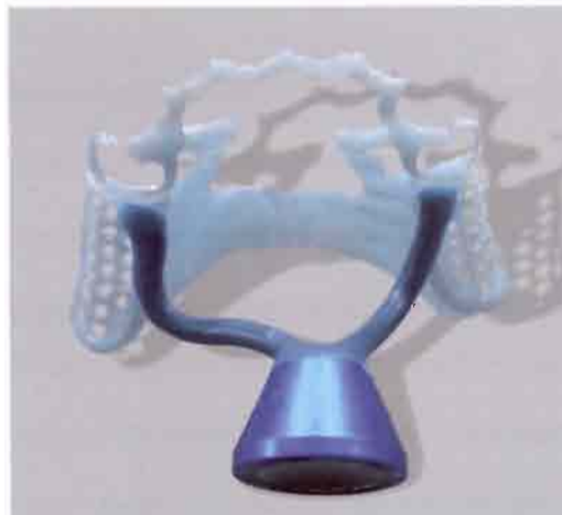
Abb. 16 Beispiel Horizontalguss: Hierfür waren zirka 400 Gramm Einbettmasse nötig, ganz abgesehen von der Aufheizzeit! Es war einmal, ...
