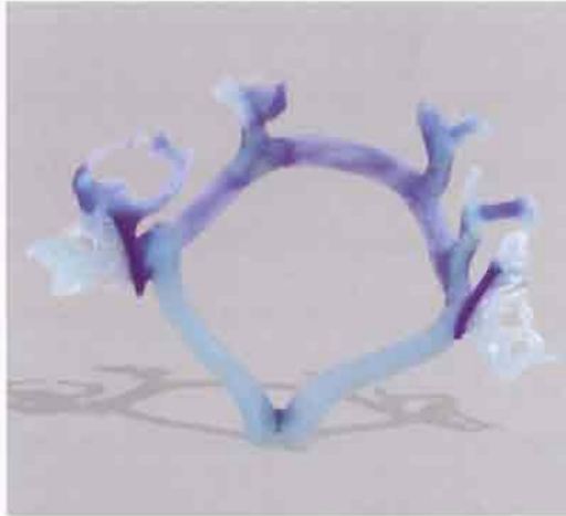
Abb. 13 Die Modellation, fertig zum Abwiegen und Einbetten für den Vertikalguss
