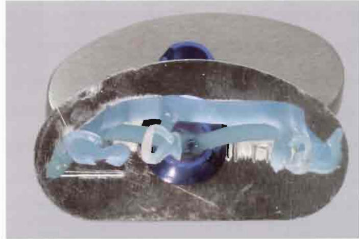
Abb. 14 Einbetten in Vertikallage: Durch das Fixieren mit dem Magneten auf der Positionierplatte kann das Objekt in alle Richtungen bewegt werden, um es genau mittig zu positionieren
