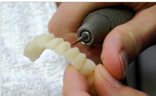
Nach dem Aushärten kann das Material mit Fräsen bearbeitet werden.
