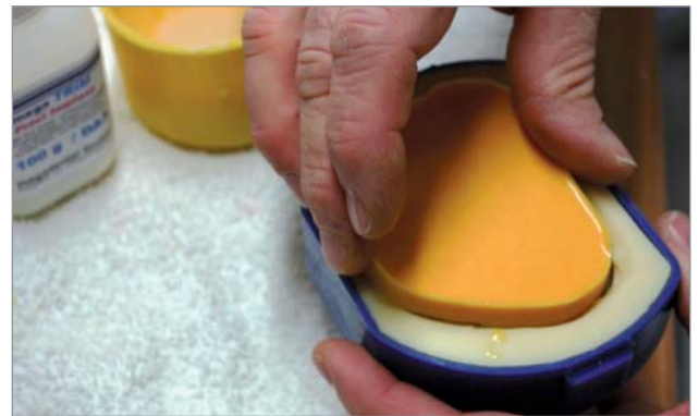
In das flüssige mega TRIM wird die orangefarbene Silikonform eingedrückt und ausgehärtet.
