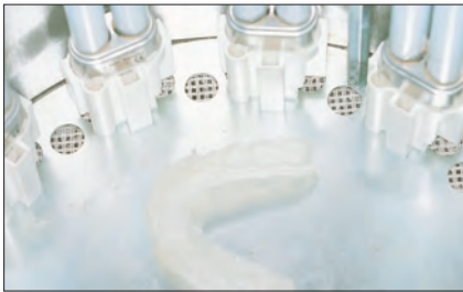
Figura 18. Fotopolimerización por la cara interna
