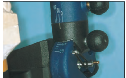
Figura 3. Ajuste de los valores de la inclinación de la trayectoria condílea y ángulo de Bennett
