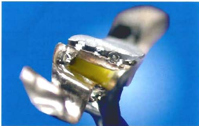
Abb. 39 In kurzen Abständen erfolgt ein Punktverschmelzen zwischen den beiden Legierungen und führt zu einer Hybridschweißung. Da die Wärmeeinflusszonen sehr gering sind, müssen die Kunststoffanteile aus den Geschieben nicht entfernt werden, denn es erfolgt keine Überhitzung.
