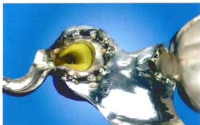
Abb. 44 Punktuelle, viele kleine Schweißpunkte unter Zuhilfenahme von Zulegematerial ermöglichen eine spannungsfreie Einschweißung dieser Geschiebestruktur.
