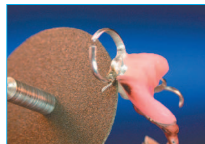
Der Überschuss wird mit einer Trennscheibe abgetrennt und die Klammer in ihre endgültige Form geschliffen.
