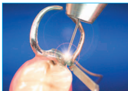
Nach dem Abheben vom Modell ist es möglich, die Fügezone auch im Inneren der Klammer komplett zu verschweißen. Auch unter Zugabe von neuem Material erfolgt eine perfekte Passung.
