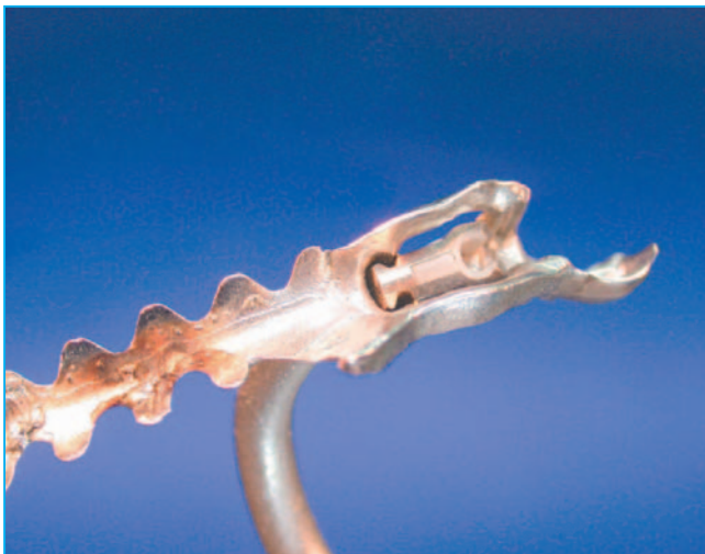
Eine Geschiebestruktur wird in einen Modellguss integriert und durch das Schweißen mit dem phaser mx1 endgültig befestigt.
