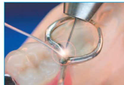
Unter Zugabe von artgleichem Material erfolgt das Auffüllen des Schweißspalts und damit eine modellierende Fügezone.
