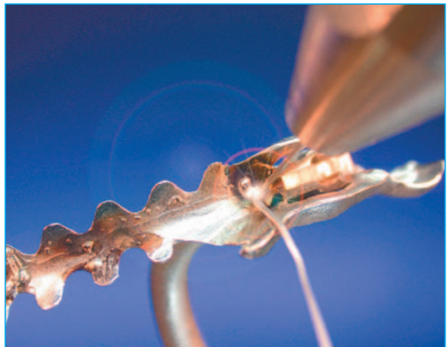
Leichte Spaltbereiche können unter Zugabe von artgleichem Material aufgefüllt und beim Schweißen gleichzeitig von der Drahtspitze mit abgetragen werden. Die letzten Schweißpunkte fixiert eine durchgehende Schweißbraupe.
