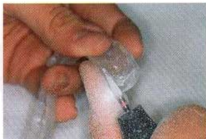
Abb. 12 Nacharbeiten mit Hilfe von Hartmetallfräsen
