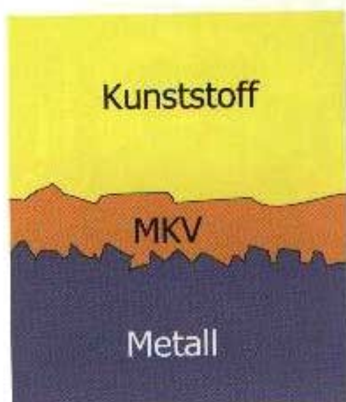
Schematische Darstellung des Metall-Kunststoff-Haftverbundes.
